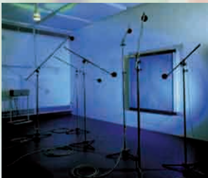
Geräuschmessung DIN 45635, Klasse 2
